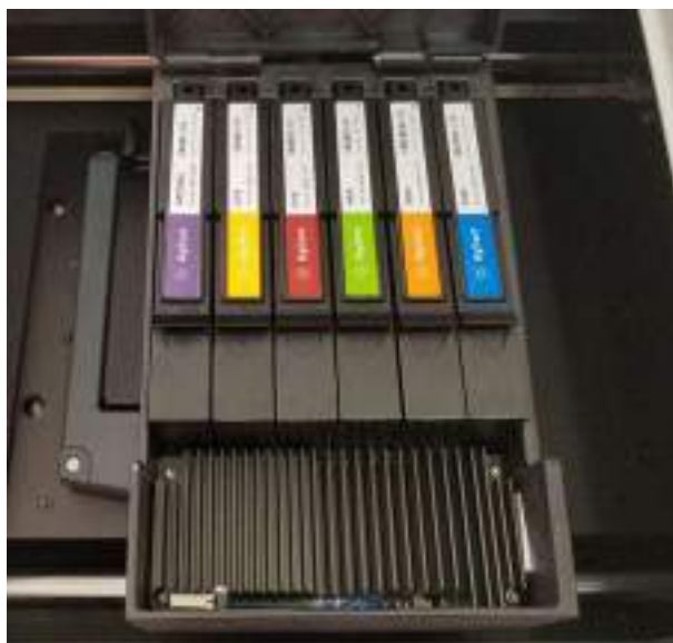
Figura 10 Módulos ópticos instalados
