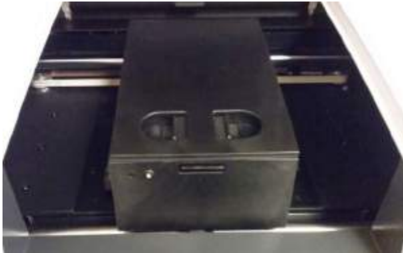
Figura 5 Soporte de la carcasa de módulos ópticos centrado en la apertura de la puerta del instrumento
