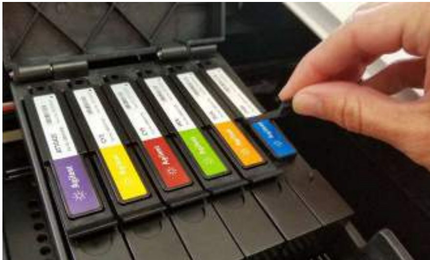
Figura 47 Elevación de la lengüeta articulada en un módulo óptico
