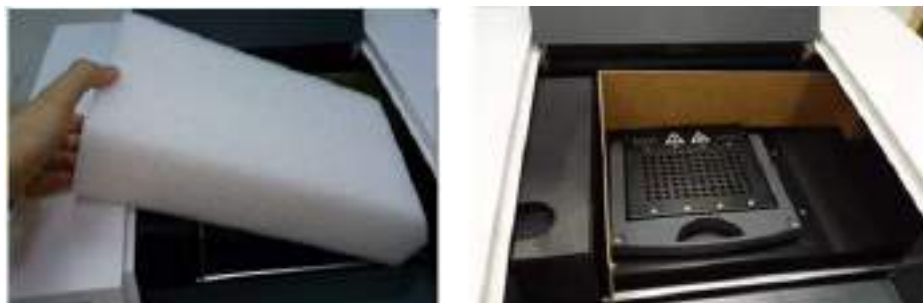
Figura 4 Inserción de espuma (izquierda) y tira de cartón subyacente (derecha).
